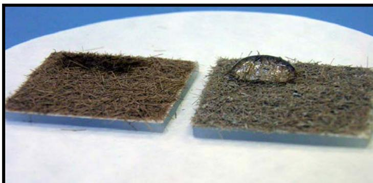
**Figura 3.** Comparativa del comportamiento de humectación del residuo de Posidonia Oceánica: fibras no tratadas (izq.) y fibras tratadas químicamente con cloruro de Palmitoilo (dcha).
