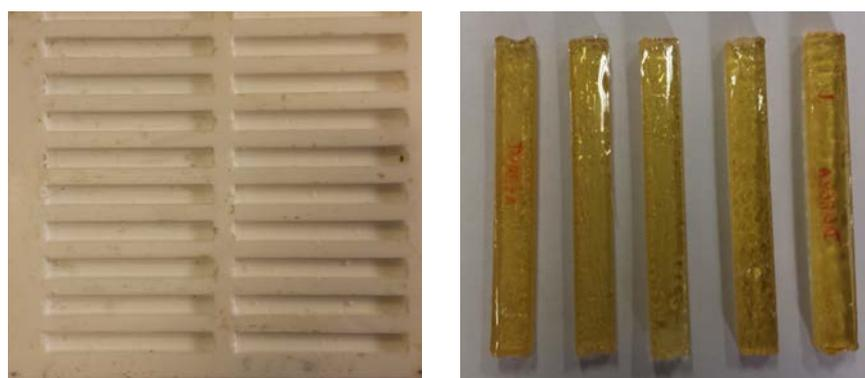
**Figura 2.** Curado de la resina de semilla de algodón con diferentes % de MNA y DDSA en molde de silicona.
