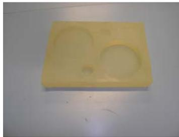
**Figura 2.** Molde utilizado para las probetas.
