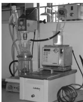
**Figura 1.** Equipo epoxidación
