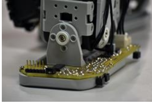
Figura 3. Circuito electrónico con los sensores instalados en el pie del robot.
