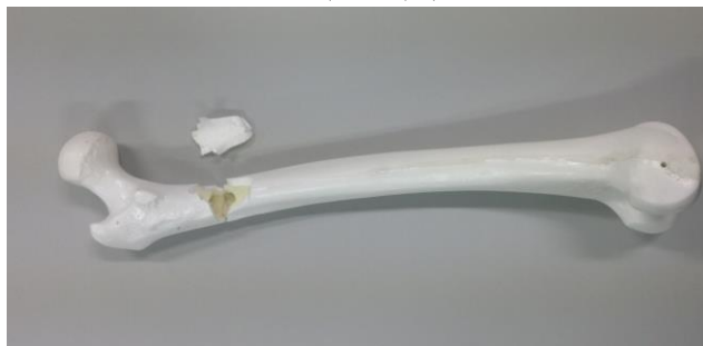
Figura 2. Resultados del ensayo de compresión del fémur artificial.
