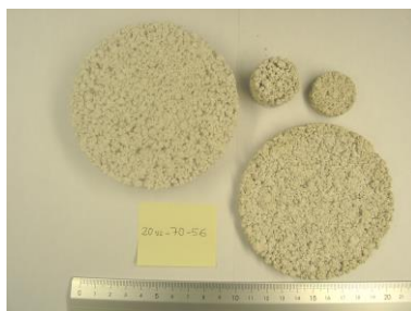
Figura 1. Dimensiones de las probetas (V2 20-70-56).
