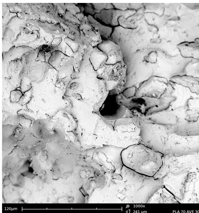
Figura 2. Micrografía de la fractura de una muestra con el 30 % en peso de cáscara de avellana a 1000 aumentos.
