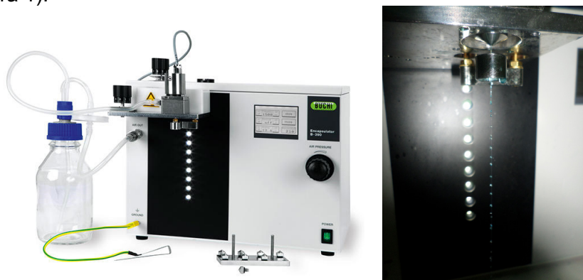
Figura 1. Equipo encapsulación B-390 Buchi y formación de la microcápsula.
