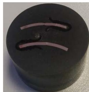
**Figura 6.** Pastilla embutida con el material.
