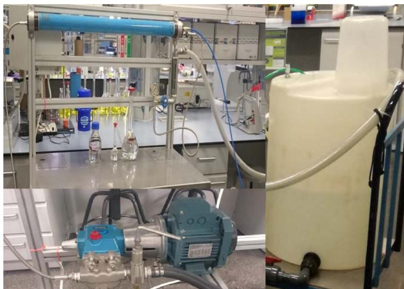
Figura 1. Planta piloto de osmosis inversa
