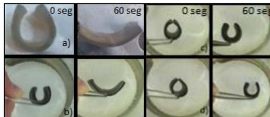
Figura 4. Ensayo térmico con agua a  $70^\circ\text{C}$ . A) SMP MM 4520. B) SMP MM 4520 + 2'5% de grafito. C) SMP MM 4520 + 5% de grafito. D) SMP MM 4520 + 10% de grafito.
