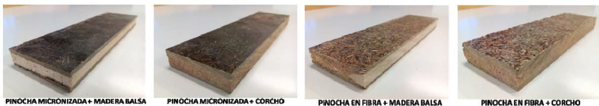
**Figura 4.** Paneles sándwich basados en las mezclas 70-30 de resinas ELO y GREENPOXY y pinocha en formato polvo y fibra.
