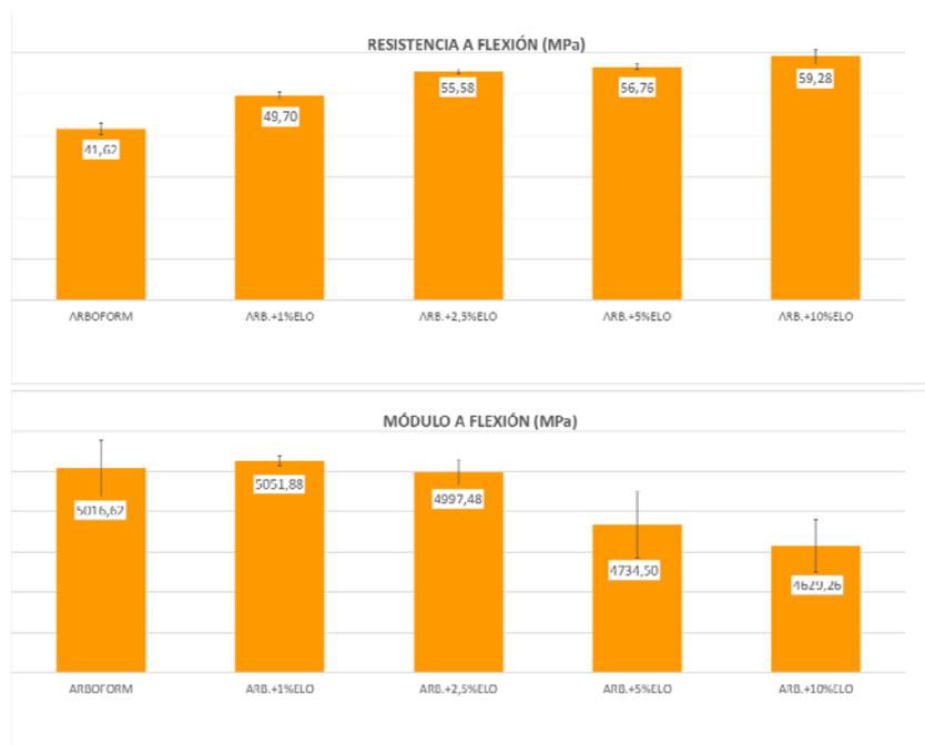
Figura 3. Resistencia y módulo de flexión de las muestras realizadas con ARBOFORM® y ELO.
