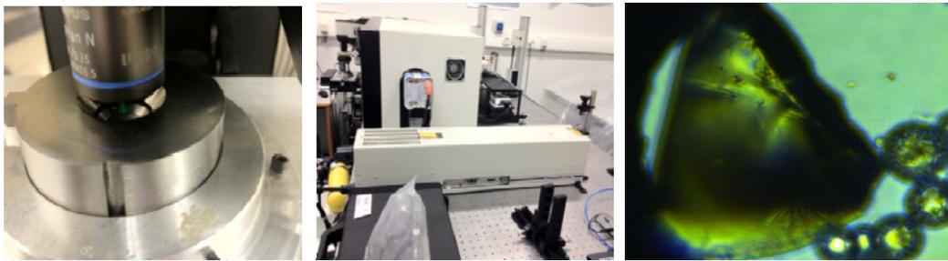
**Figura 2.** Celda de diamante (izquierda), espectrómetro Raman (centro) y cámara de visualización (derecha)
