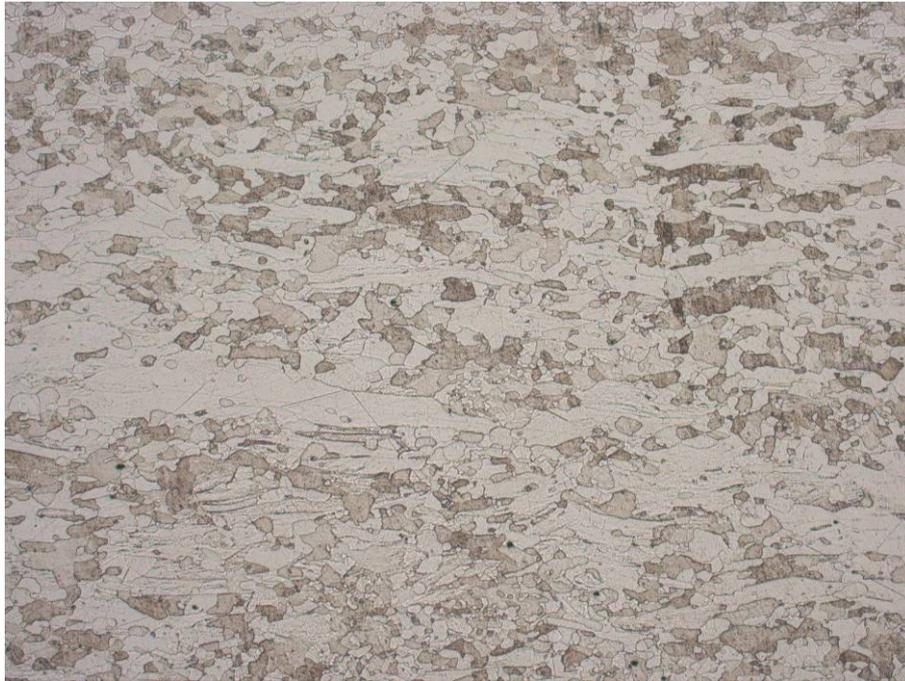
**Figura 9.** Ejemplo de ataque en material 1.4512, 100x, reactivo villeda.
