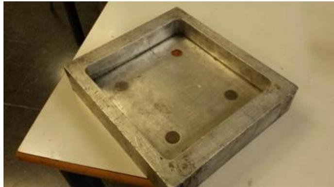
**Figura 2.** Molde para termoconformado.
