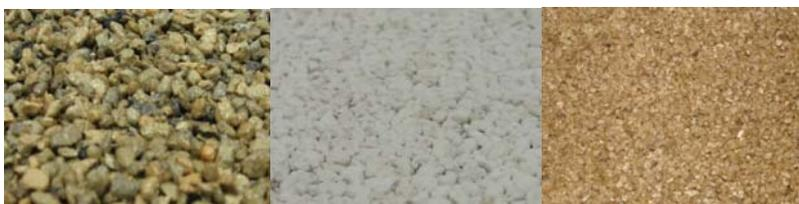
**Figura 1.** Izquierda: Arlita. Centro: Perlita. Derecha: Vermiculita.
