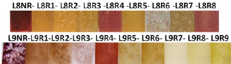
**Figura 5.** Muestras de biocompuestos generadas con el colorante rojo NR, y los nanopigmentos según los experimentales L8 y L9.
