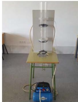
Figura 6. Equipo de resistencia al flujo.
