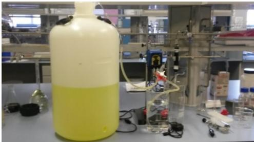
**Figura 3.** Sistema de adsorción montado con bomba peristáltica y flujo descendente de solución
