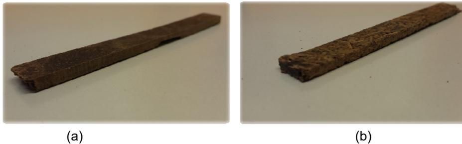
**Figura 3.** (a) Probeta normalizada elaborada por termo compresión, empleando pinocha micronizada. (b) Probeta normalizada elaborada por termo compresión, empleando pinocha en fibra triturada.
