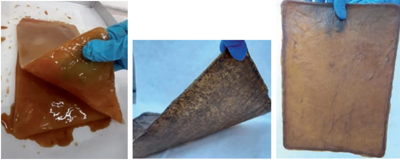
Figura 4. Material alternativo al cuero basado en celulosa bacteriana.
