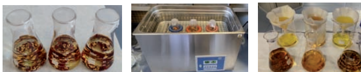
Figura 2. Proceso de extracción mediante ultrasonidos.
