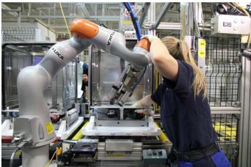
**Figura 2.** Robot en colaboración con un trabajador.
