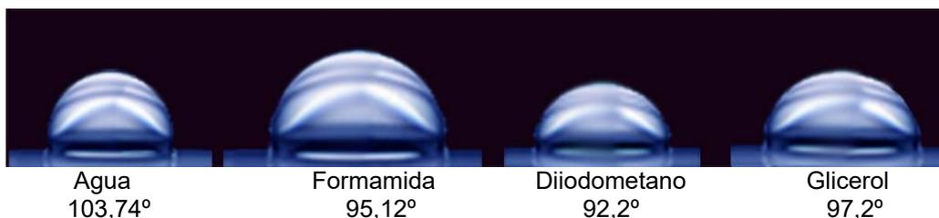
**Figura 1.-** Gotas de cada líquido de medida sobre la superficie del polipropileno.
