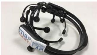
Figura 2. Equipo de electroencefalografía. Emotiv EPOC+
