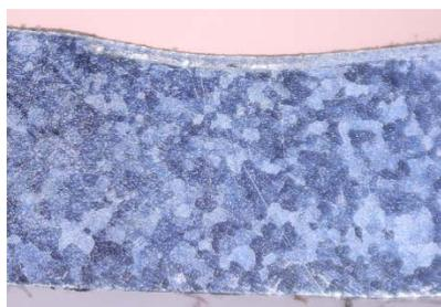
**Figura 5.** Microestructura acero inoxidable grado UNE EN 14512 300x ateque vilella
