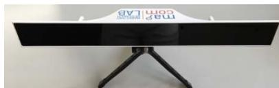
Figura 3. Equipo de Eye Tracking. Gaze Point 3
