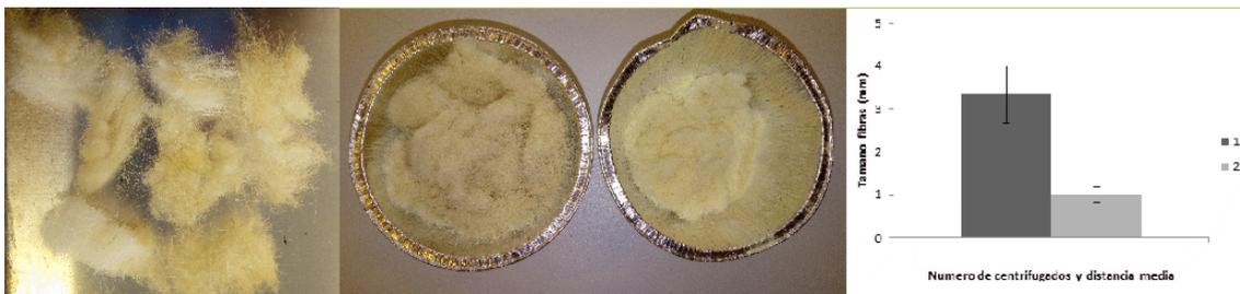
**Figura 5.** Corte de la fibra de lana con tijera o guillotina (Imagen de la izquierda), corte mediante centrifuga (imagen central) y gráfica de tamaño medio de las fibras dependiendo del número de centrifugados.
