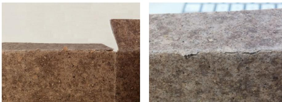
**Figura 3.** Fabricación de la caja y problemática de rotura en el proceso de doblado.
