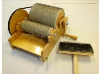
**Figura 3.** Cardadora manual para alinear fibras.
