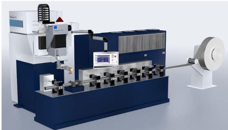
Cuando ya se han tenido los parámetros optimizados para una velocidad determinada del 50% de la velocidad máxima de línea, se ha ido incrementado la velocidad y reajustando los parámetros de proceso hasta ver cuando aparecía una desestabilización de la soldadura siendo inestable y comenzando a parpadear la luz de la soldadura.
