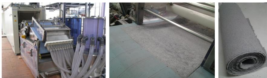
Figura 2. Fabricación de no tejidos wet laid a partir del residuo de borra textil.
