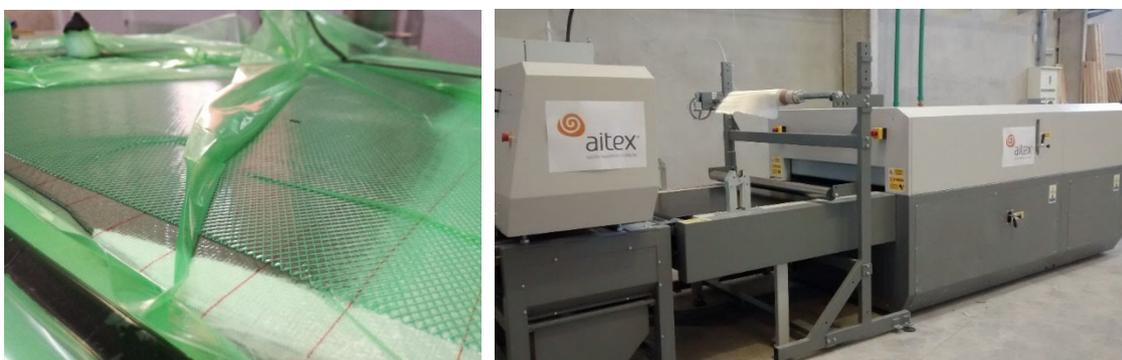
**Figura 1.** Proceso de infusión de resina (izq.) y laminación en continuo (dcha.)
