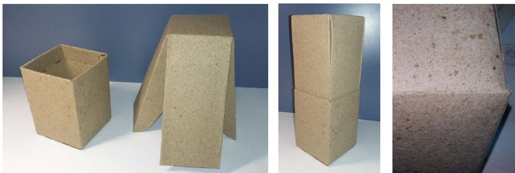
**Figura 4.** Caja de envasado y embalaje de botellas de aceite de oliva virgen a partir de residuo de orujo (50%), residuo de cartón (30%), fibras de lyocell (10%) y de PLA (10%).
