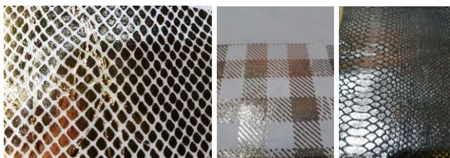
**Figura 3.** Ejemplo de transferencias de efectos conseguidos mediante calandra sobre tejido de poliéster y piel.
