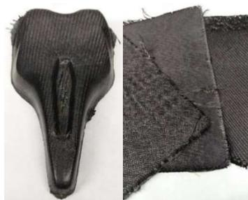
**Figura 5.** Sillín termoconformado a partir de tejidos de material compuesto de fibras de carbono y resina termoplástica.
