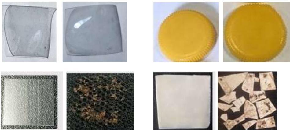
**Figura 3.** Imágenes de las probetas antes del ensayo (izquierda) y tras 8 semanas (derecha). Superior izquierda: PET. Superior derecha: PP. Inferior izquierda: PLA. Inferior derecha: PHB.
