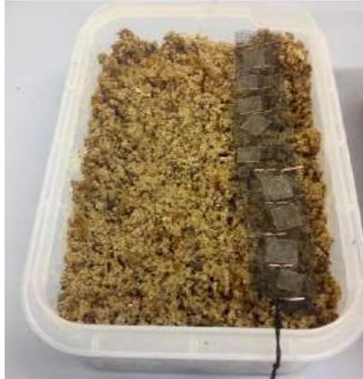
**Figura 2.** Imagen del reactor con el compost y muestras poliméricas de PLA.
