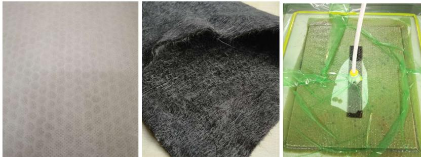
**Figura 4.** Izqda. Núcleo honeycomb de polipropileno. Centro. No tejido de carbono. Dcha. Proceso de compactación al vacío.
