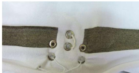
**Figura 4.** Electrodo para ECG y ritmo cardíaco
