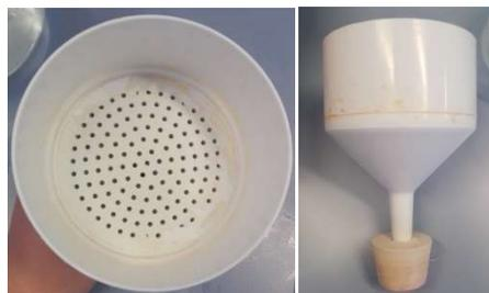
**Figura 1.** Filtro cerámico sobre el que se sustenta el filtro de fibra de vidrio. a) Vista superior. b) vista de perfil.
