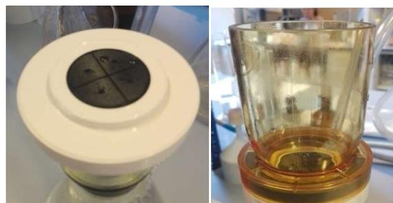
**Figura 2.** Filtro de soporte magnético para sustentar el filtro de fibra de vidrio. a) zona inferior b) zona superior.
