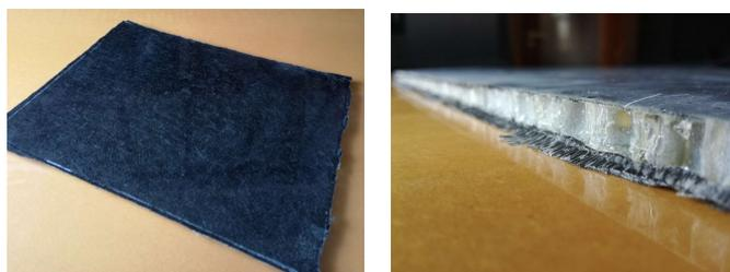
**Figura 5.** Panel sándwich obtenido mediante laminación manual y compactación al vacío.
