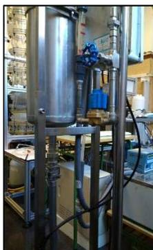
**Figura 1.** Sistema de membranas utilizado para la extracción de las STH.
