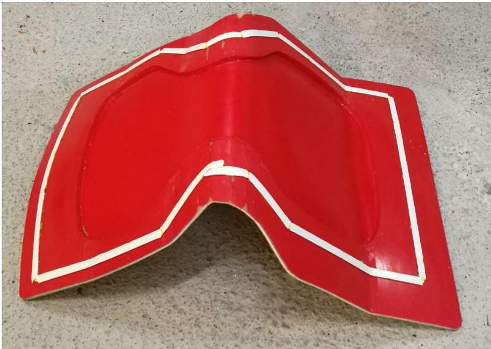
**Figura 2.** Molde infusión empleado para la elaboración de silla.
