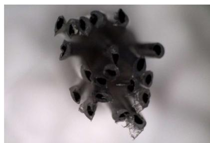
**Figura 2.** Filamento de carbono recubierto de polímero termoplásticos mediante el proceso coating.
