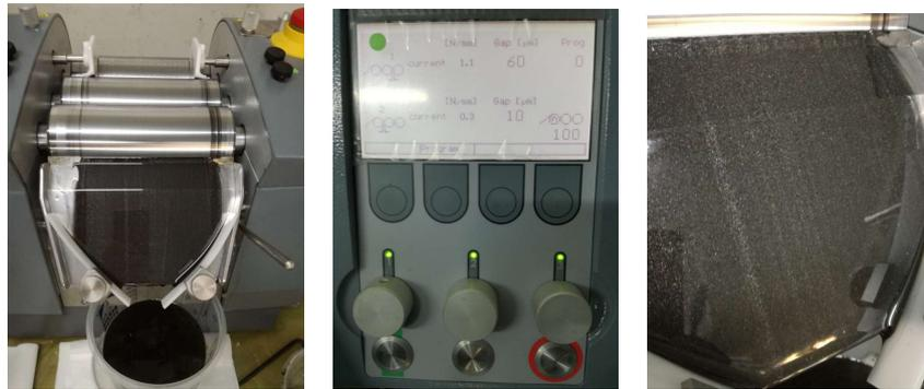
**Figura 1.** Proceso de aditivación de la resina
