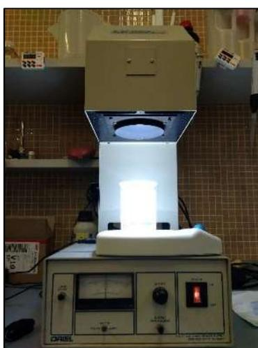
Imagen 3. Simulador solar utilizado en los experimentos foto-Fenton.
