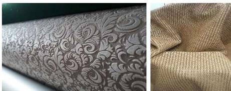
**Figura 1.** Ejemplos de tejidos y materiales tipo piel procesados con láser. Izquierda: efecto de marcado y corte sobre tejido. Derecha: efecto de marcado y corte sobre piel.
