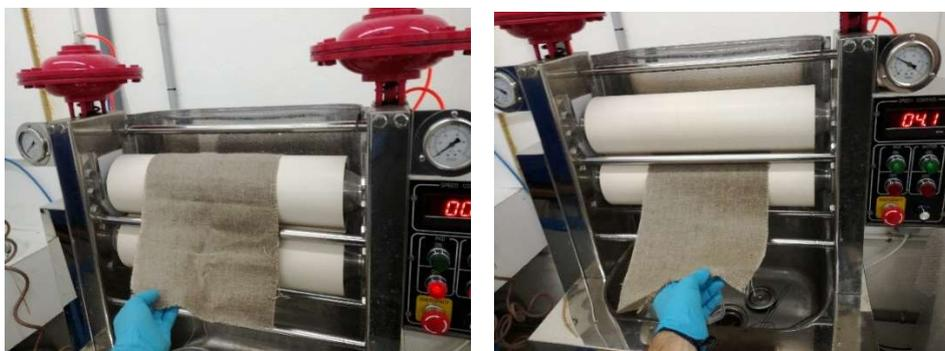
Figura 1. Proceso de foulardado de las muestras de tejido de cáñamo.
