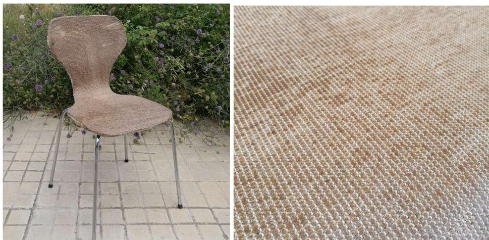
Figura 3. Prototipo y detalle de la silla obtenido empleando residuos de alfombra.
