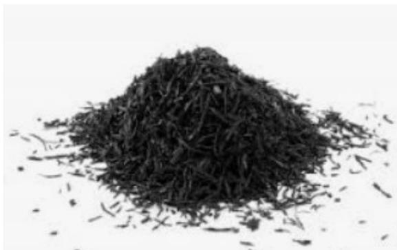
**Figura 1.** Residuo de refuerzo textil de neumático usado.
