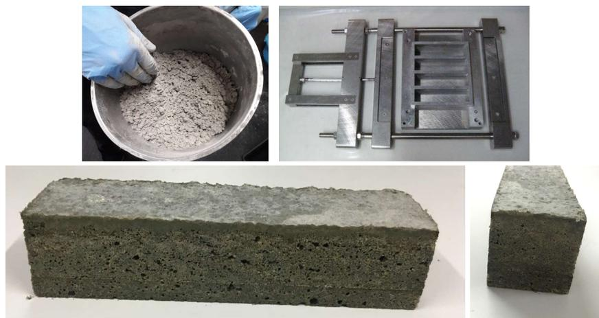
**Figura 4.** Fabricación de materiales de matriz inorgánica a partir del residuo de refuerzo textil de neumático usado.
