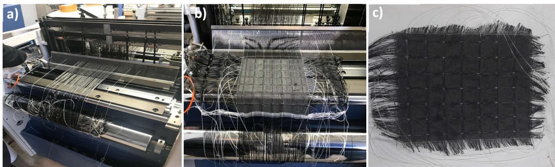
Figura 5. (a), (b) Planta piloto de tejeduría (AITEX). (c) Tejido de fibra de carbono con POF incorporada.
