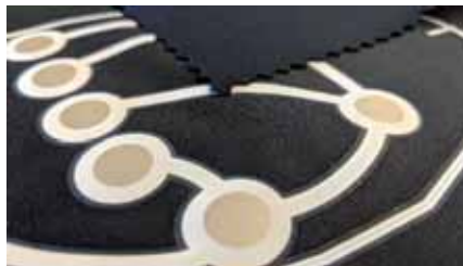
Figura 1. Detalle sensores de tipo electrodo impresos multicapa sobre sustrato textil.
