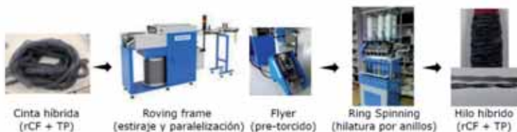
Figura 2. Manipulación de cinta y proceso de hilatura
