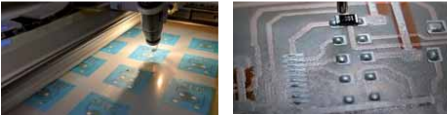
Figura 2. Proceso montaje superficial electrónica híbrida con componentes de silicio.
