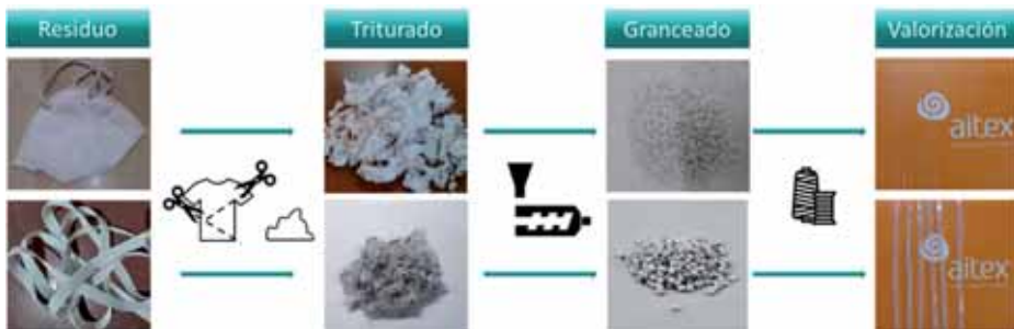
Figura 2. Ejemplos de valorización de residuos de mascarillas y de cintas de persiana mediante la obtención de monofilamento y cinta plana.
