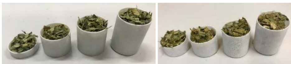
Figura 1. Muestras de hojas de naranjo trituradas sin aglutinante (izquierda) y con aglutinante (derecha).
