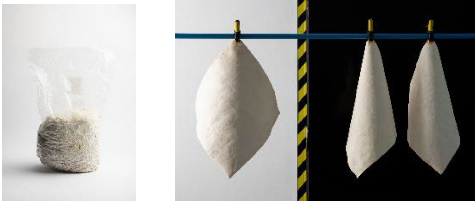
Figura 3. (Izq.) Proceso de multiplicación del micelio (Dcha.) Material obtenido por fermentación estática.
