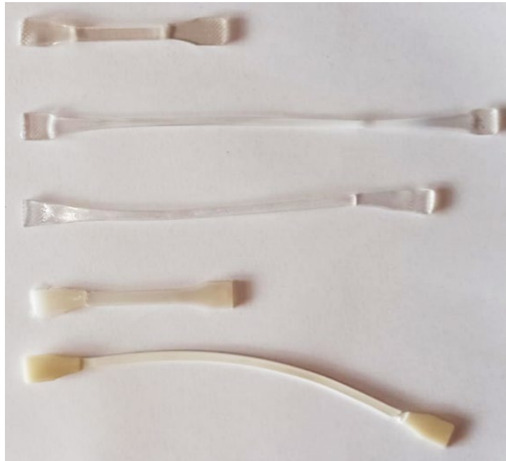
Figura 2. Muestras tras la rotura. De arriba hacia abajo: la primera muestra es del PLA virgen, sin plastificante; la segunda muestra es del PLA + 20% DIPT; la tercera muestra es del PLA + 20% DMT; la cuarta muestra es del PLA + 20% Toco.Ac. y la quinta muestra es del PLA + 20% Toco.Su.
