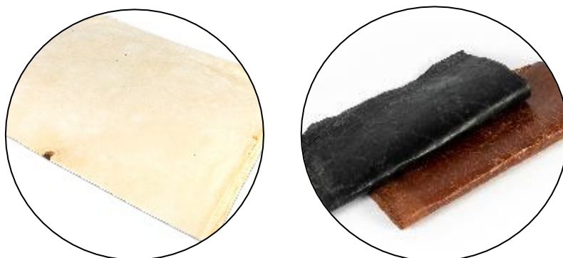
Figura 4. (Izq.) Material original obtenido por fermentación líquida estática. (Dcha.) Distintos tipos de material acabado.
