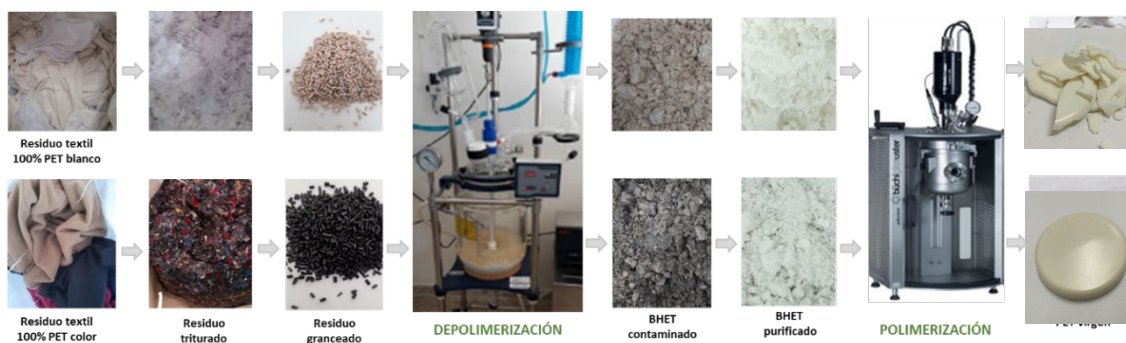
Figura 3. Resultados obtenidos tras el reciclado químico de los residuos textiles de poliéster
